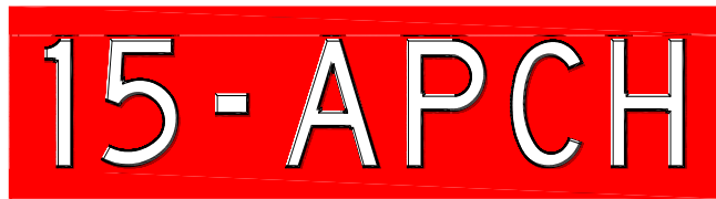
Figura 2. c. Letrero de Posición de Espera Pista en Áreas de Aproximación
