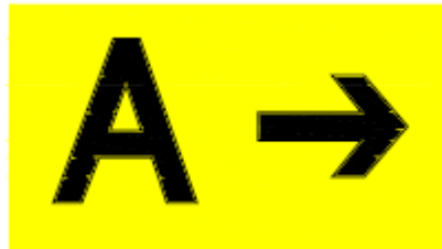
Figura 9. a. Letrero de dirección / salida de pista
