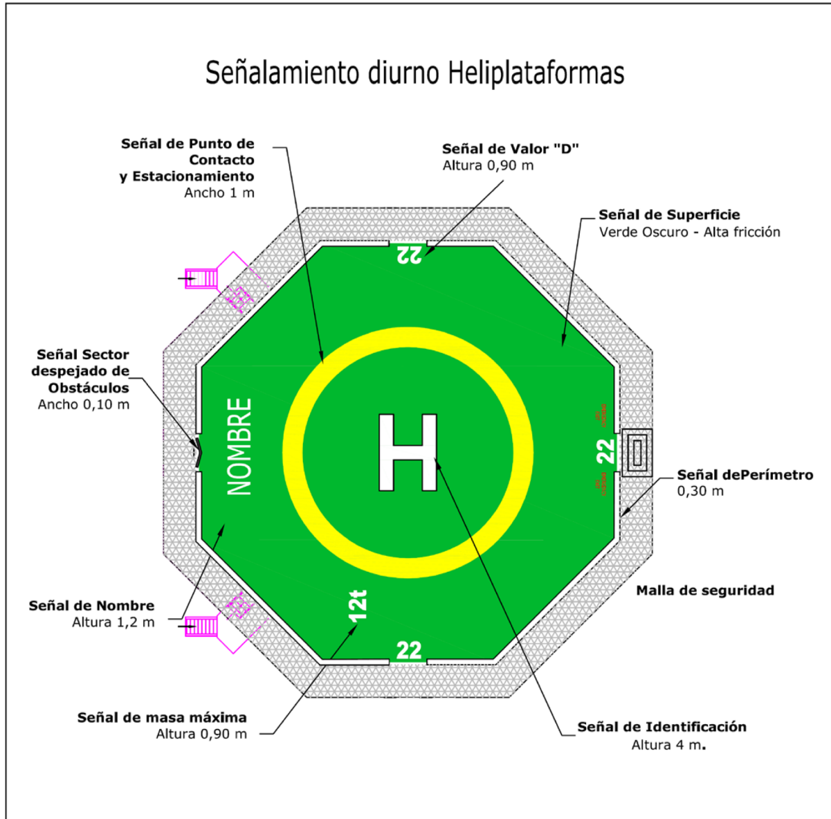
Figura A-5-8. Señalamiento de heliplataforma
