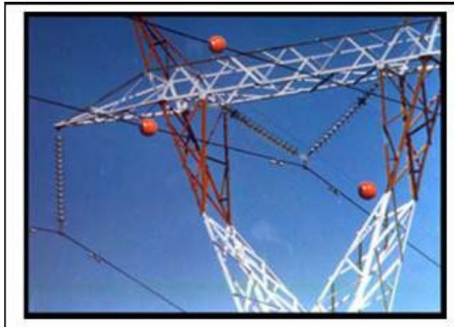
Figura 4-2. Señalamiento de líneas de tensión con esferas de un solo color
